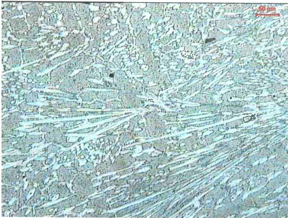
Figura 26 – B8 com aumento de 200X. Estrutura hipoeutética com carbonetos de cromo espalhados na matriz
