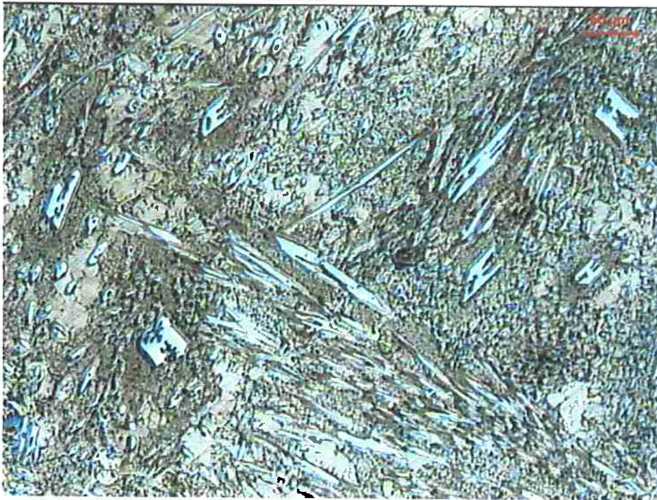
Figura 44 – C4-II com aumento de 200X. Estrutura eutética
