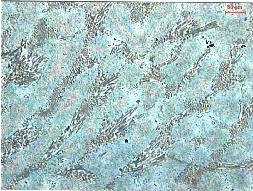
Figura 24 – B7 com aumento de 200X, estrutura dendrítica com carbonetos de cromo entre as dendritas. Estrutura hipoeutética
